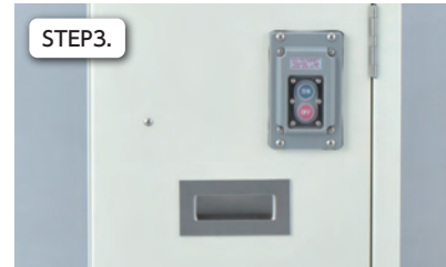
STEP3. 電源(AC100V)に接続し、電源ボタンを押す ※発電機を使用する場合、出力が2.2kVA以上必要
